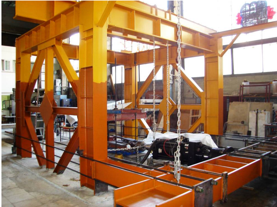
Σχήμα 2. Έμβολο 200 τόνων συνδεδεμένο με το πλαίσιο αντίδρασης στο εργαστήριο Πειραματικής Αντοχής των Υλικών και των Κατασκευών του τμήματος Πολιτικών Μηχανικών του Α.Π.Θ. εν λειτουργία
